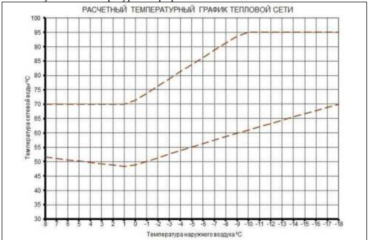
Рисунок 5. Температурный график 115 - 70 °С для отопления с ГВС.
