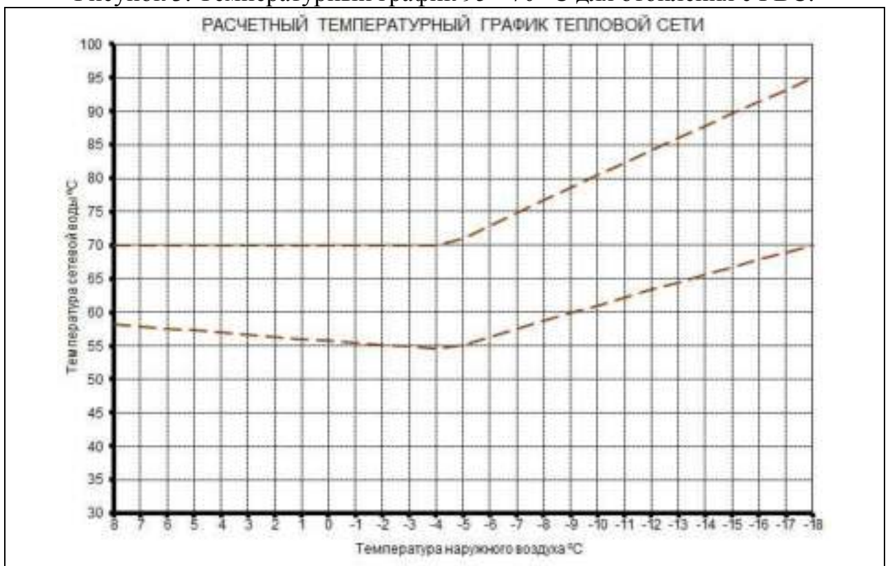
Рисунок 3. Температурный график 95 - 70 °С для отопления с ГВС.
